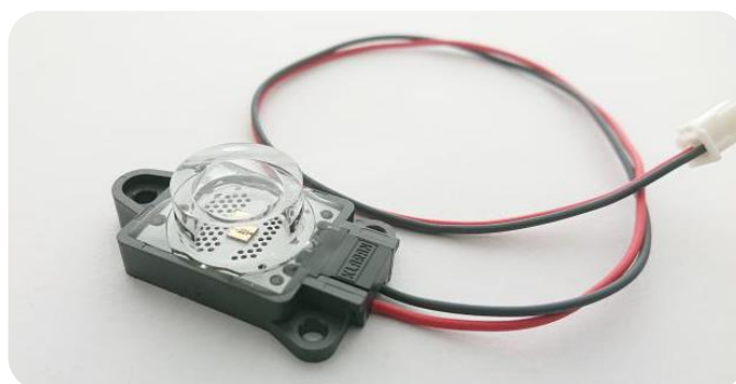
写真 1) エンプラス製 UVC 光学素子搭載の旭化成株式会社製 UVC LED ユニット
